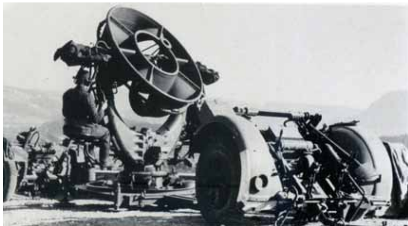
Aerofono della Luftwaffe in servizio d'ascolto in territorio rumeno. L'apparato acustico di rilevamento è del tipo mobile autorimorchiato su piattaforma girevole. Questo aerofono tedesco ( Ring-trumpet type ) era formato da quattro trombe montate su una singola unità a forma di anello.
