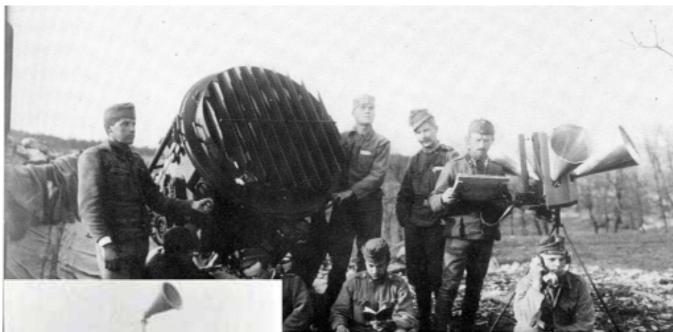
L'avvistamento aereo a distanza veniva effettuato nella prima guerra mondiale con apparati acustici abbinati a fotoelettriche come il modello raffigurato nella foto in dotazione al Regio Imperiale esercito austriaco.
