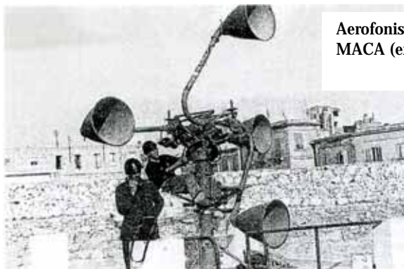
Marinai italiani in azione con l'Aerofono O.G. 41 a Monte Patella sull'isola di Leros, dove vi era anche il muro d'ascolto, 1942.
